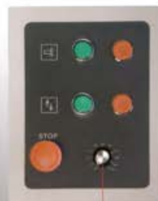
Stepless speed variation adjustment button 無段階調整ポリコーム
